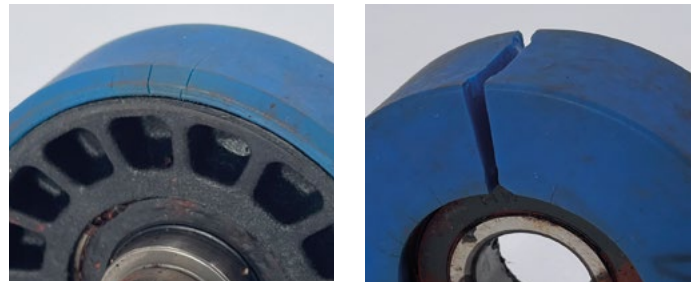
在80° C的水中浸泡1,000小时后，滚轮水解造成的损坏
